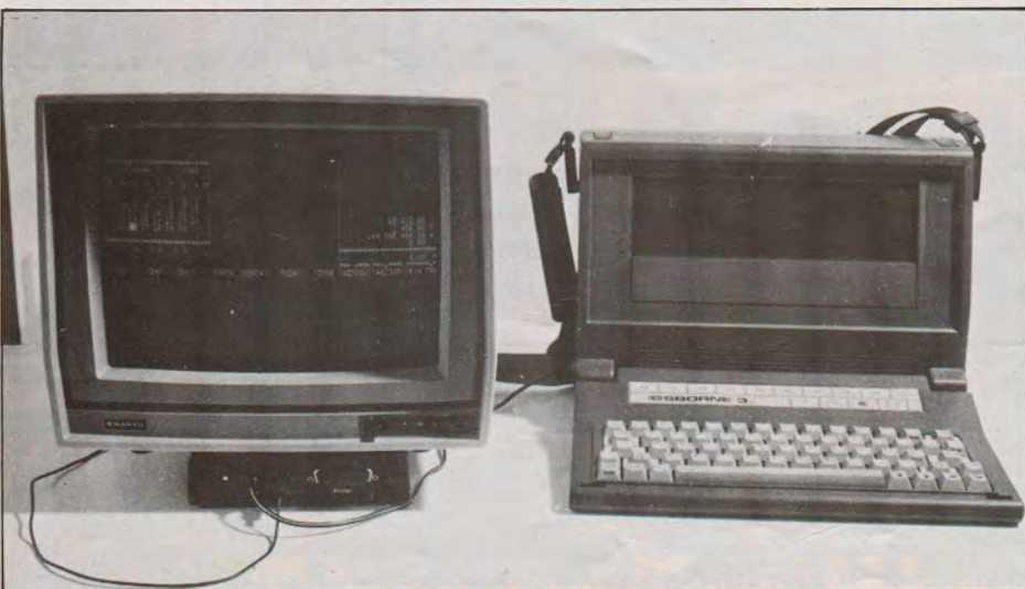
Ο Encore σε σύνδεση με εξωτερικό monitor το οποίο κάθεται πάνω στον Adaptor. Η εικόνα μιλάει μόνη της.
